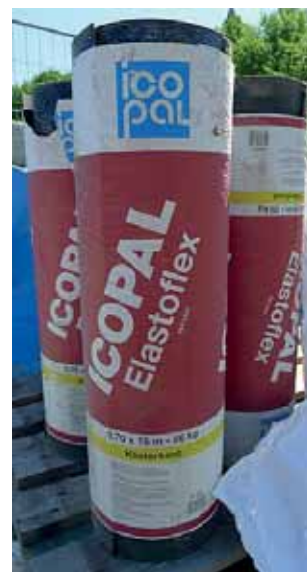
Icopalpappen har en stomme av polyesterfilt. Stommen är impregnerad och belagd med bitumen.
