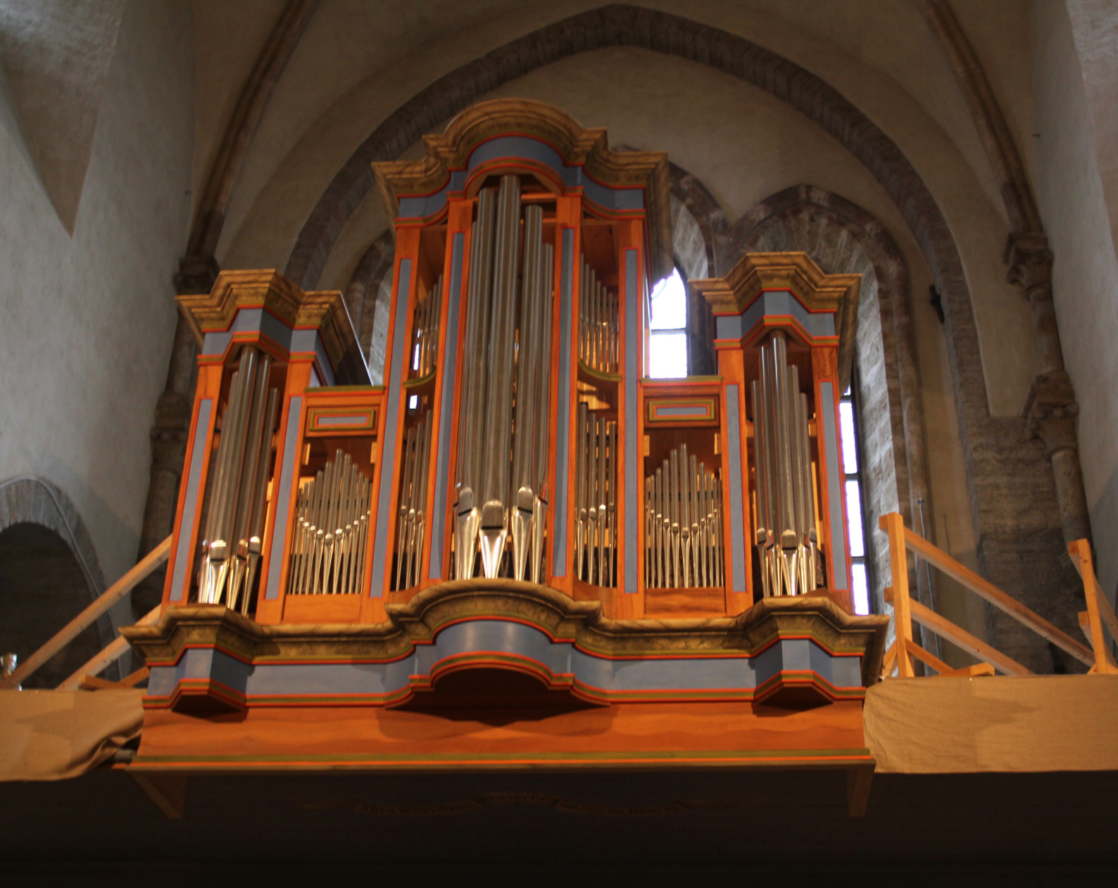
Ryggspositivet till De la Gardie-orgeln monterat i Varnhems Klosterkyrka, med påbörjad ytbehandling.
